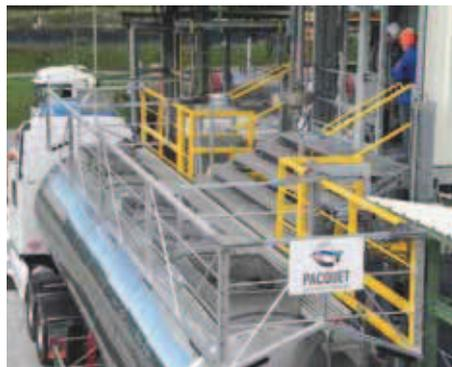
d'arc de cercle sans possibilité d'ajustement précis, notre arceau de sécurité temporaire s'adapte de manière optimale aux différentes typologies de citernes rencontrées sur les sites de production. Cela permet une combinaison des mouvements d'élévation, d'inclinaison, voire translation selon le modèle, pour une adaptation optimale à la citerne. Nous venons d'installer la centième passerelle sur site, avec
