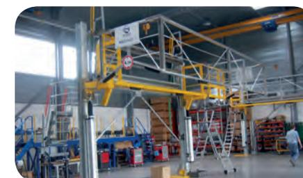
La Passerelle MONTE & BAISSÉ®, brevetée en France et à l'international, est une passerelle d'accès assurant la mise en conformité sécurité des personnels pour les accès et travaux en dôme de citerne. La finalité : lutter contre le risque de chute de hauteur.
