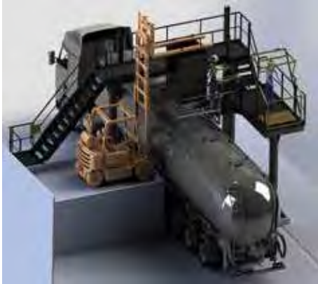
Plan 3D et réalisation sur site d'une passerelle d'accès sécurisé.
